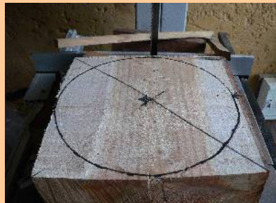
Le cercle est hors- champ et se trouve dans l'écorce si l'on utilise le centrage des diagonales. Il est nécessaire de faire un décalage radial.
