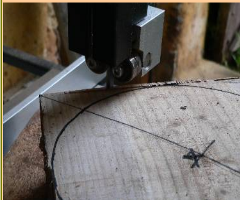
Rognage des angles pour l'équilibrage. Fin des opérations sur la scie à ruban.
