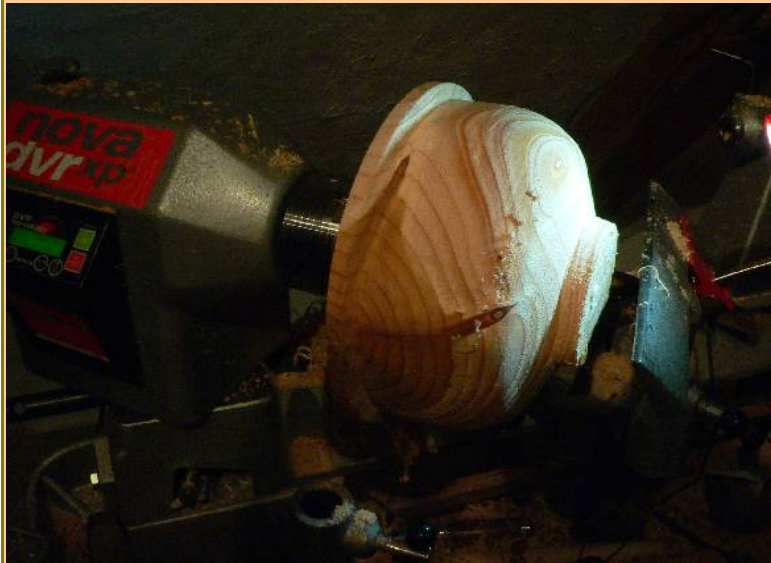
Ébauche du talon de reprise pour l'inversion avant creusage.
