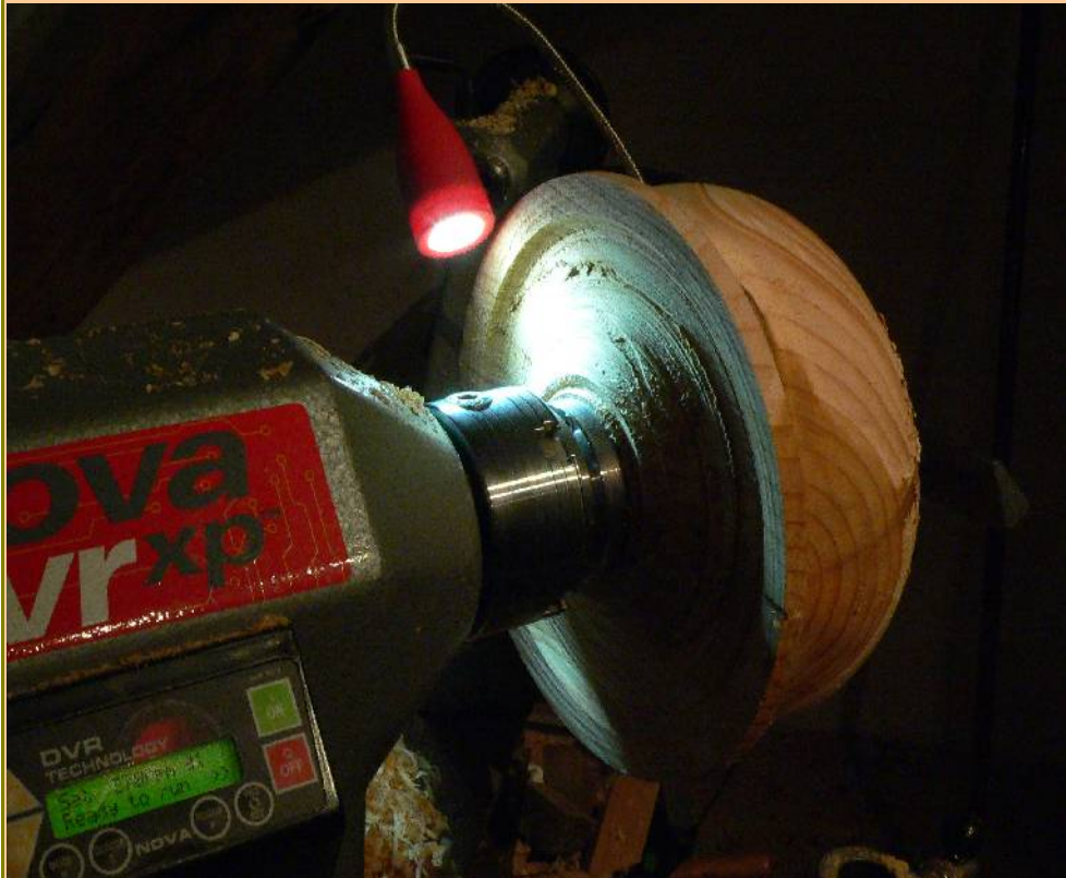
Avant l'inversion cette partie va faire l'objet du creusage. Un ébauchage du rebord est profilé.
