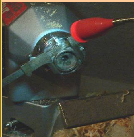
Prise de cotes de la capacité du mandrin pour façonnage d'un talon de reprise.
