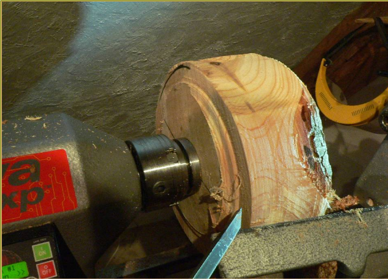
Observation du cercle de traçage et de la coupe de calibrage décalage et rognage de l'écorce . Le bois de cèdre est sans aubier.
