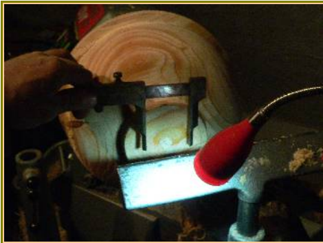
Report sur la face du talon avant son creusage. Le fond accepte les mâchoires du mandrin en extension.
