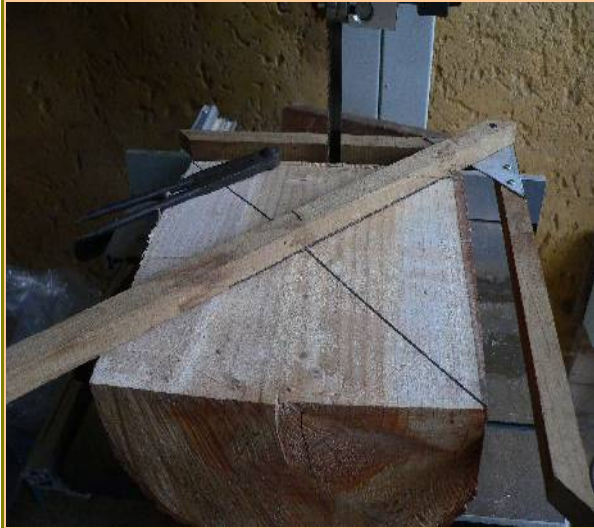
Traçage des diagonales pour le centrage d'un cercle donnant le gabarit de tournage.
