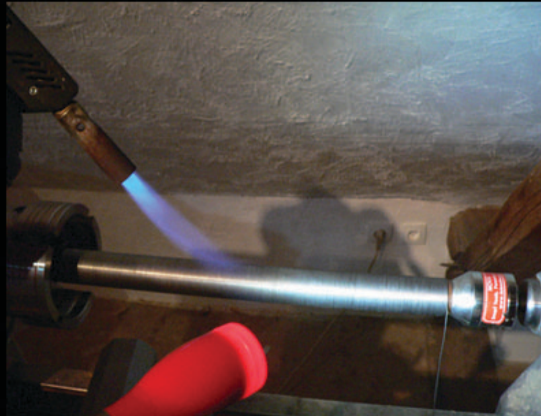
Premier feu pour éliminer les contraintes. Feuille de calcul http://smart2000.pagesperso-range.fr/calculer%20une%20resistance.htm
