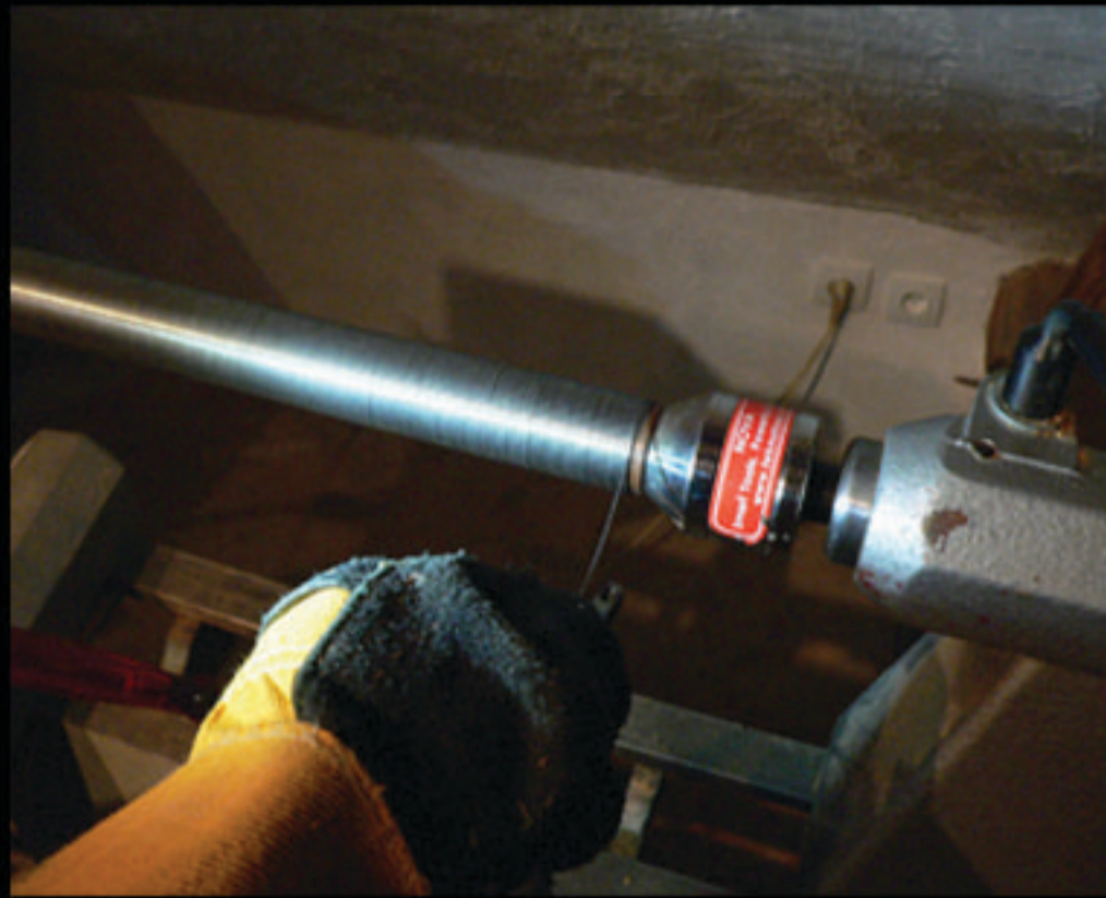
Fin de l'enroulement 100 tpm Protections conseillées
